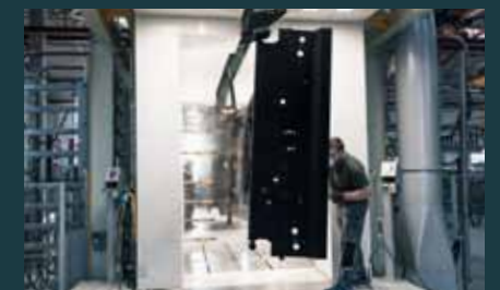
Automatyczne malowanie proszkowe
