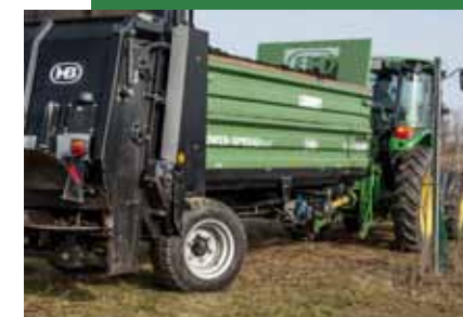
Innowacja firmy Brantner opcjonalna hydrauliczna oś skrętna
