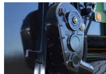
Bezstopniowy napęd podłogi przesuwnej solidna przekładnia zamontowana w kąpiel olejowej
